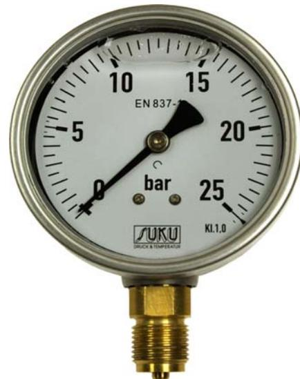
Für Messstellen mit hohen dynamischen Druckbelastungen und Vibrationen. Die Glycerinfüllung sorgt für einen ruhigen Zeigerlauf und damit für eine gute Ablesbarkeit selbst bei extremen Belastungen und starker Rüttelbeanspruchung. Die Schmierwirkung des Glycerins wirkt sich außerdem günstig gegen erhöhten Verschleiß aus.
